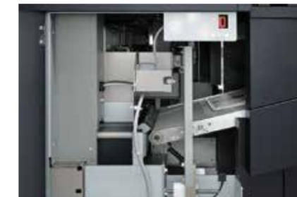
La section de réception conçue de manière unique évite l'endommagement des dos. Même les ouvrages de 65 mm d'épaisseur ou les ouvrages reliés en PUR peuvent être réceptionnés sans endommagement ni marquage.
