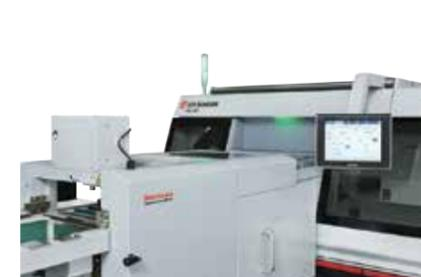
Un mécanisme d'alimentation de conception unique permet d'alimenter et d'enregistrer automatiquement des corps d'ouvrages à épaisseurs variables.
