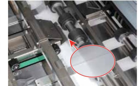
La largeur et la position du rainage sont automatiquement réglées en fonction de l'épaisseur des corps d'ouvrages et du positionnement des couvertures. Le rainage est effectué sur des couvertures épaisses pour une reliure professionnelle avec des dos carrés et nets, et un rainage sur le pli d'aisance.
