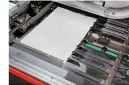
Après le transport vers la section d'emboîtement, la couverture est positionnée avec précision à l'aide des guides de positionnement du bord avant et du bord arrière.
