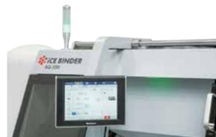
L'écran tactile couleur de 12,1 pouces est muni d'icônes pour une utilisation conviviale. La configuration, le fonctionnement et le réglage fin peuvent être effectués à partir de l'écran tactile.
