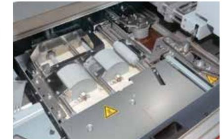
Des cylindres à double application et des cylindres d'encollage latéral assurent une application de colle supérieure au dos des ouvrages et une excellente adhésion de la couverture pour une reliure de qualité constante. La hauteur des cylindres de colle, la minuterie de l'ouverture et de l'arrêt de la lame (déterminant la longueur d'encollage), la hauteur du cylindres à racler et la largeur du cylindres d'encollage des mors sont automatisées.
