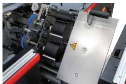
Les cylindres d'application de collage, les cylindres d'essuyage arrière et le loquet de débrayage permettent un accès facile pour le nettoyage du bac.
