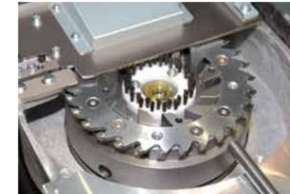
Un puissant mécanisme de grecquage/fraisage servocommandé grecque/fraise le dos des corps d'ouvrages ou des cahiers pour une pénétration optimale de la colle. La vitesse de rotation du grecquage/fraisage peut être ajustée automatiquement en fonction de l'épaisseur des ouvrages et des gabarits personnalisés. La profondeur de grecquage/fraisage peut-être réglée de 0 à 4 mm.
