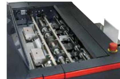
Un dispositif optionnel de rejet de couvertures est disponible pour rejeter les couvertures qui ne correspondraient pas aux bons corps d'ouvrages.
