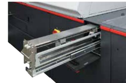
Dispositif optionnel de fente des couvertures pour fendre les deux bords de la couverture afin d'éliminer le surplus pour une manipulation facile et une précision accrue au niveau de la coupe trois lames.
