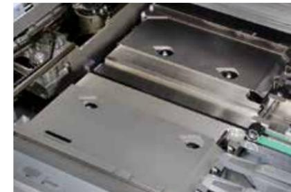
Un mécanisme d'emboîtement puissant et rigide et un taquage performant garantissent un alignement précis de la couverture sur le corps d'ouvrage et les dos carrés. La largeur et la hauteur d'emboîtement, le temps de fonctionnement et le délai d'attente sont automatiquement ajustés en fonction de l'épaisseur de l'ouvrage.
